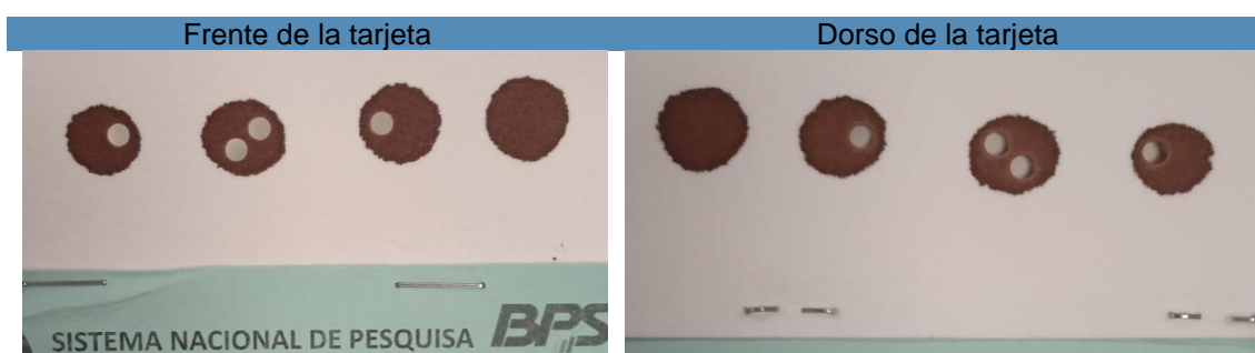
Figura 7: muestra válida con perforaciones realizadas en el LPN para procesar pesquisa.
